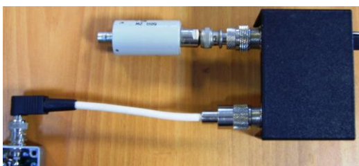
Тест_передатчик – кабель – КСВ_метр – нагрузка 50 Ом.
