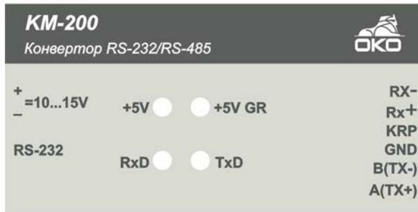
Рис.4. Индикация состояния KM-200
