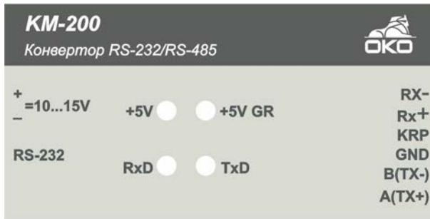
Рис.4. Индикация состояния KM-200
