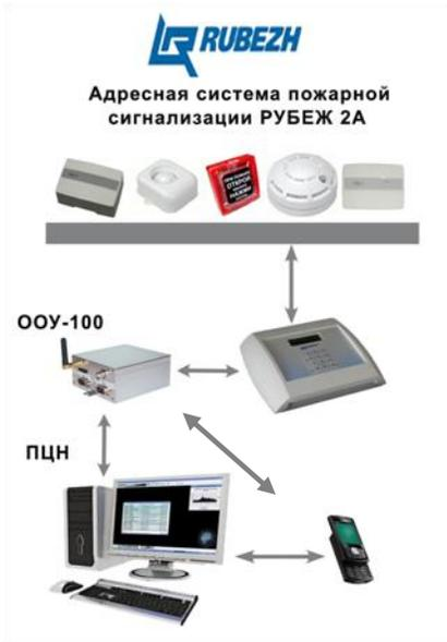
Рис. 4. Подключение АС «Рубеж-2А» к системе «ОКО».
