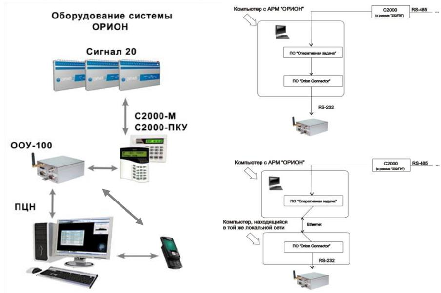
Рис. 3. Подключение оборудования ИС «Орион» к системе «ОКО».
