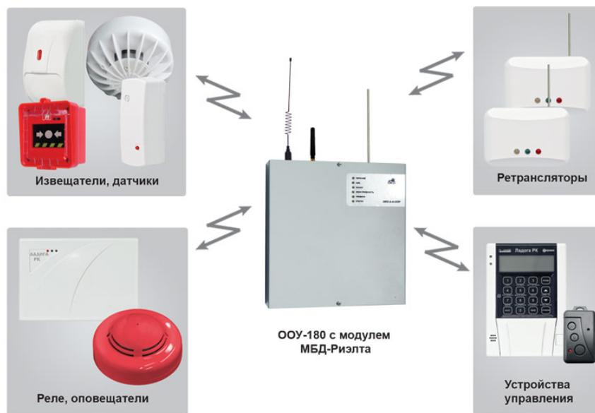
Рисунок 2.3 – Структурная схема взаимодействия ОКО-ПК с устройствами беспроводной системы Ладога РК
