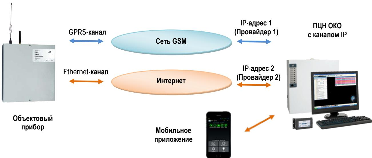
Рисунок 4.2 – Схема связи.
