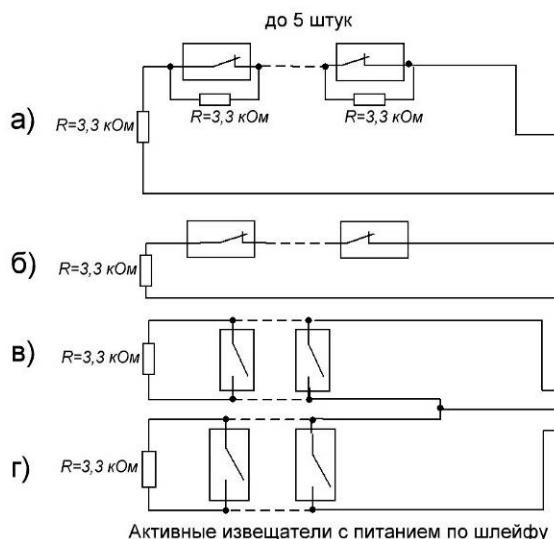
Рисунок П5 – Схема подключения датчиков к базовому блоку ООУ-180. а) Шлейф с контролем 4-х состояний. б) Шлейф с контролем 3-х состояний с извещателями с нормально замкнутыми контактами. в) Шлейф с контролем 3-х состояний с извещателями с нормально разомкнутыми контактами. г) Активный пожарный извещатель.
