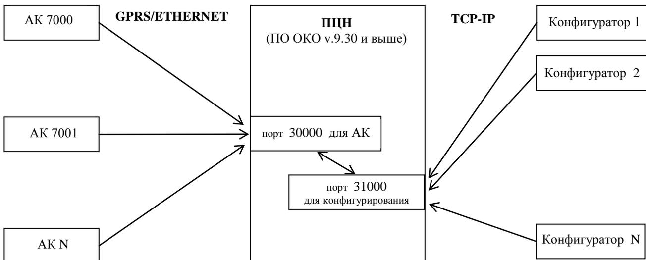
Рисунок 6.3 – Схема связи
