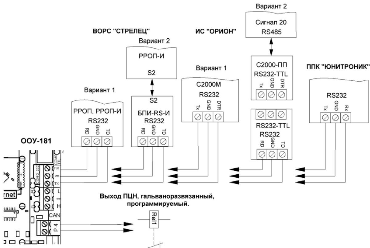
Рисунок П6-а – Схема подключения внешних систем через интерфейс RS-232. При подключении ИС «Орион» согласно варианту 1 используется протокол обмена «ОПС «Болид»», при подключении согласно варианту 2 используется протокол «LONTA 202».
