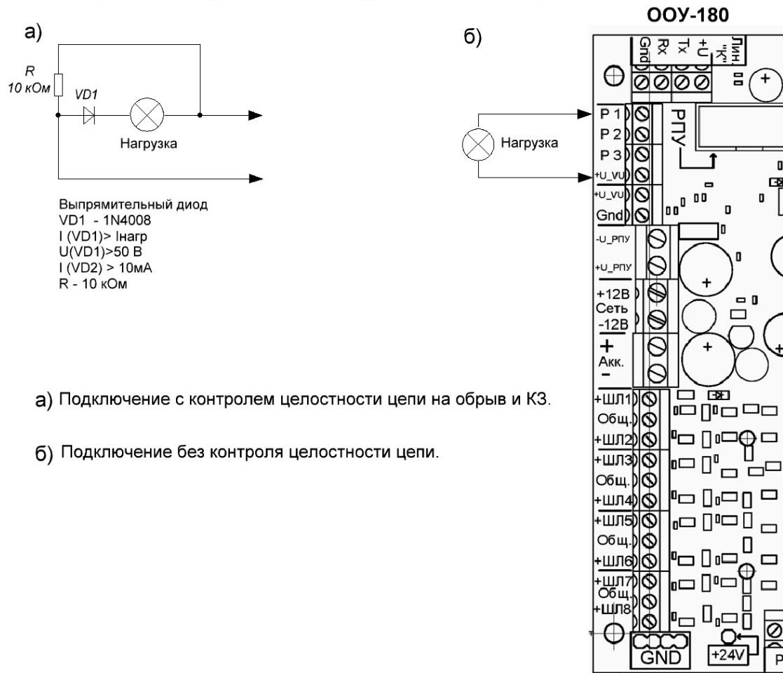
Рисунок П2 - Схема подключения к релейным выходам Р1...Р3.
