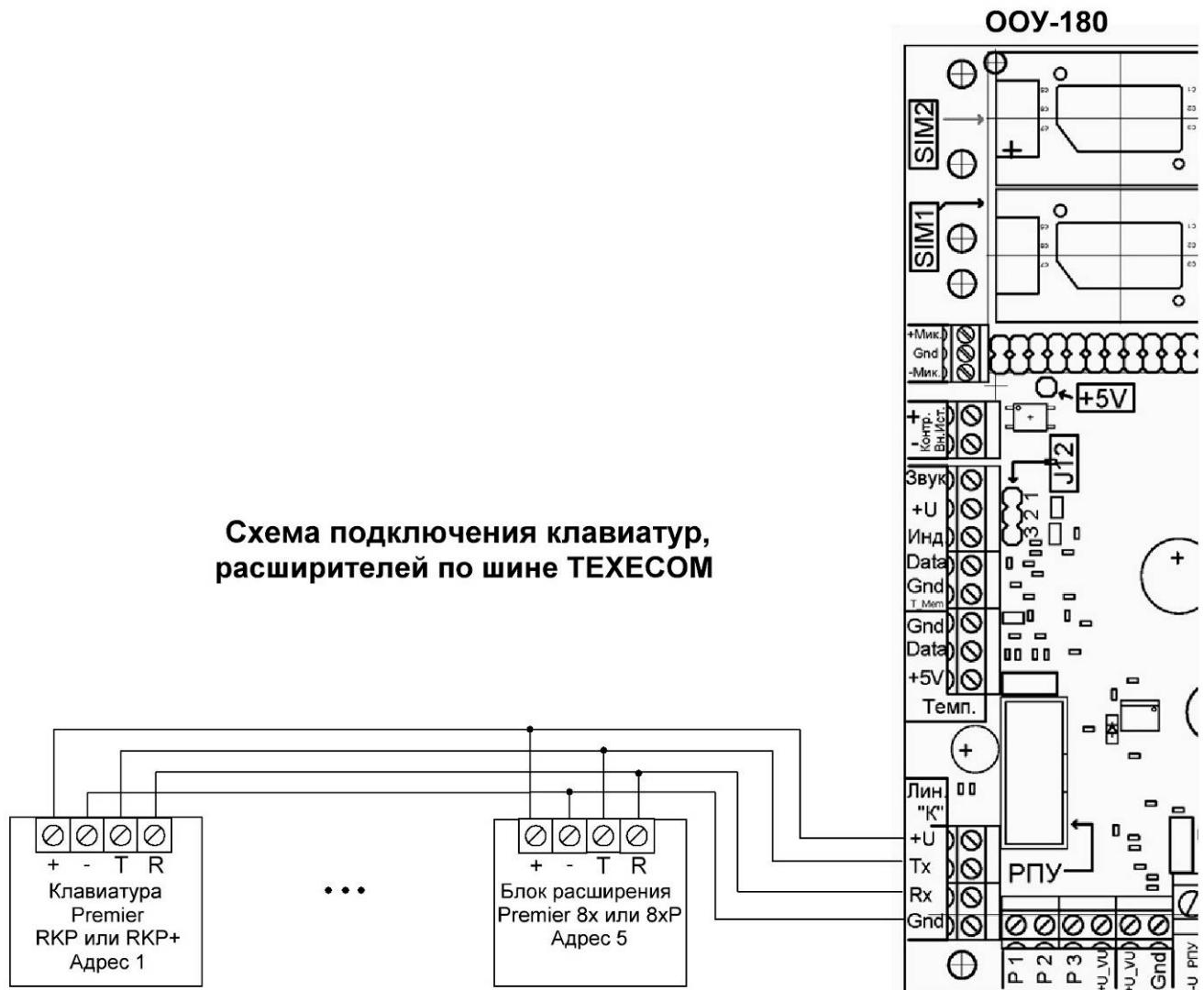
Рисунок П3 - Схема подключения блоков расширения TEXECOM.
