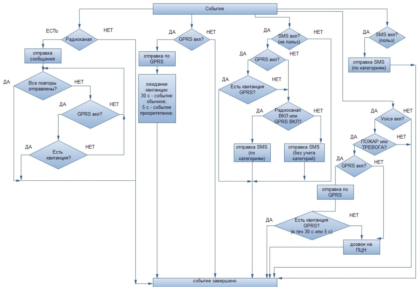
Рисунок 4.3 – Алгоритм работы по каналам связи ОКО-ПК.
