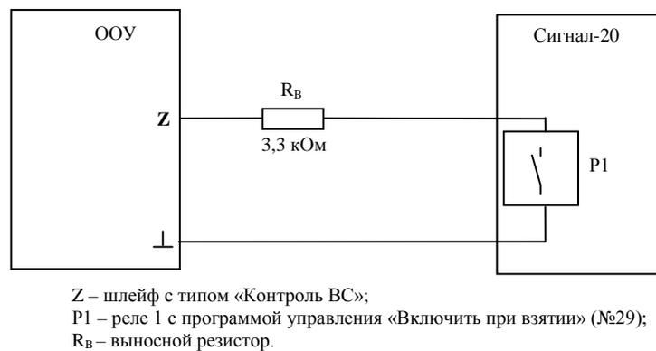
Рисунок П9 – Схема подключения прибора «Сигнал-20» через релейный выход для формирования извещений «Снятие с охраны ВС» и «Постановка на охрану ВС».
