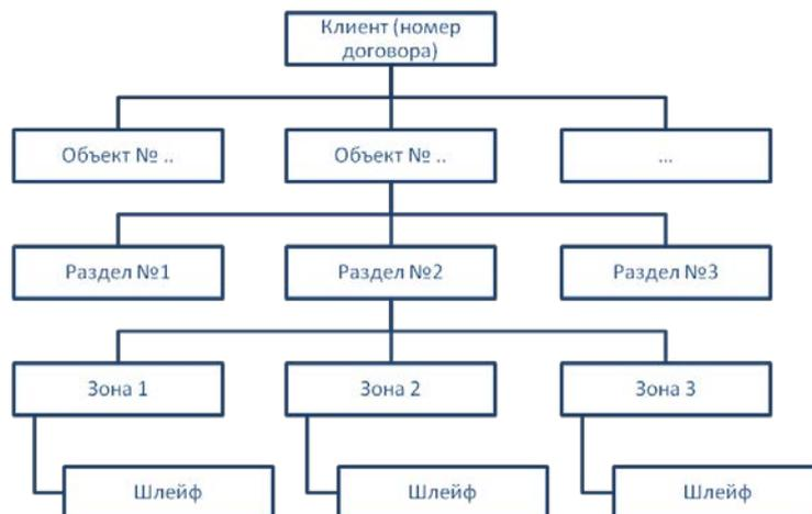
Рисунок 4.1 – Схема разбиения объекта на разделы и зоны.
