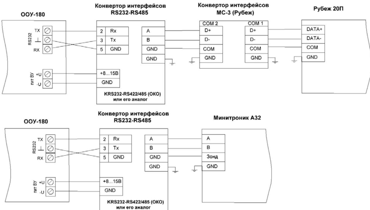
Рисунок П6-б – Схема подключения внешних систем Рубеж 2ОП (протокол LONTA 202) и Минитроник А32 через интерфейс RS-485.
