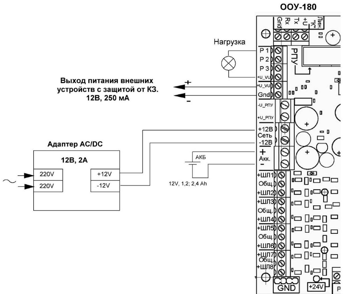
Рисунок П1 - Схема подключения питания к ООУ-180.
