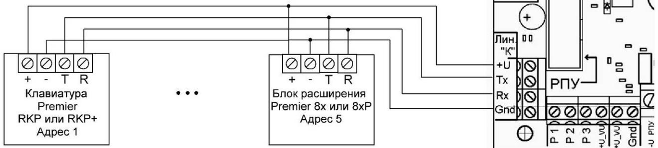
Рисунок ПЗ - Схема подключения блоков расширения ТЕХЕСОМ.
