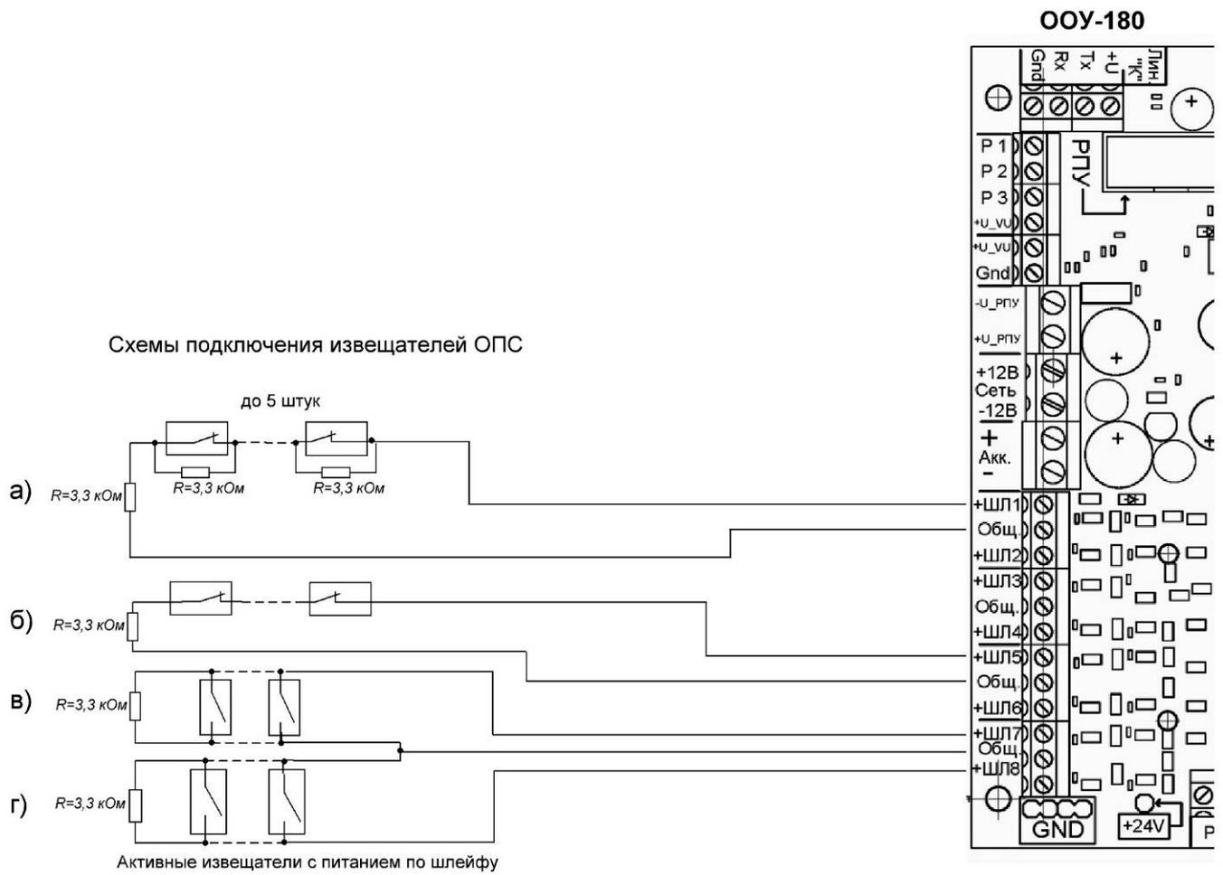
Рисунок П5 – Схема подключения датчиков к базовому блоку ООУ-180. а) Шлейф с контролем 4-х состояний. б) Шлейф с контролем 3-х состояний с извещателями с нормально замкнутыми контактами. в) Шлейф с контролем 3-х состояний с извещателями с нормально разомкнутыми контактами. г) Активный пожарный извещатель.
