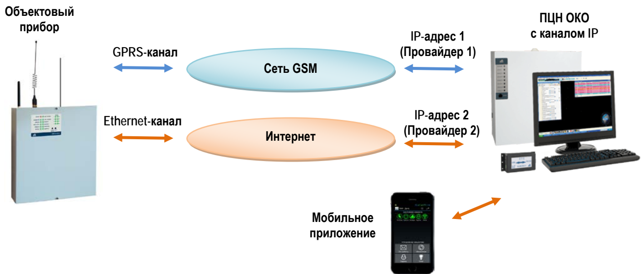
Рисунок 4.2 – Схема связи по GSM и Ethernet каналу.
