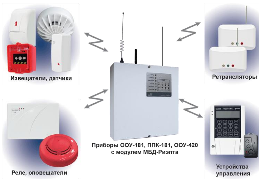
Рисунок 2.3 – Структурная схема взаимодействия ООУ-420 с устройствами беспроводной системы Ладога РК
