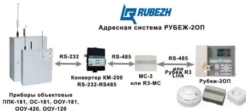
Рис.5. Структурная схема подключения Рубеж-2ОП
