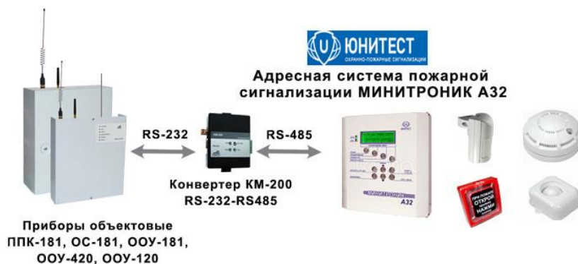
Рис.7. Структурная схема подключения Минитроник А32
