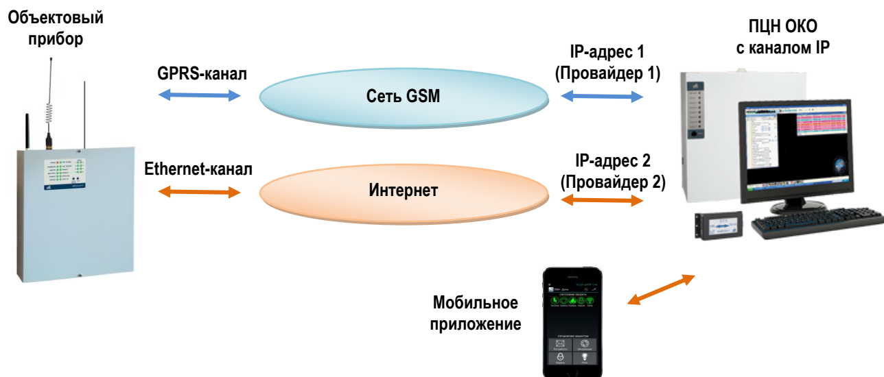
Рисунок 4.2 – Схема связи по GSM и Ethernet каналу.
