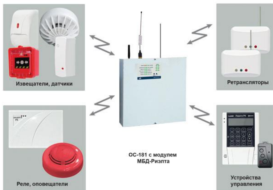
Рисунок 2.3 – Структурная схема взаимодействия прибора ОС-181 с устройствами беспроводной системы Ладога РК
