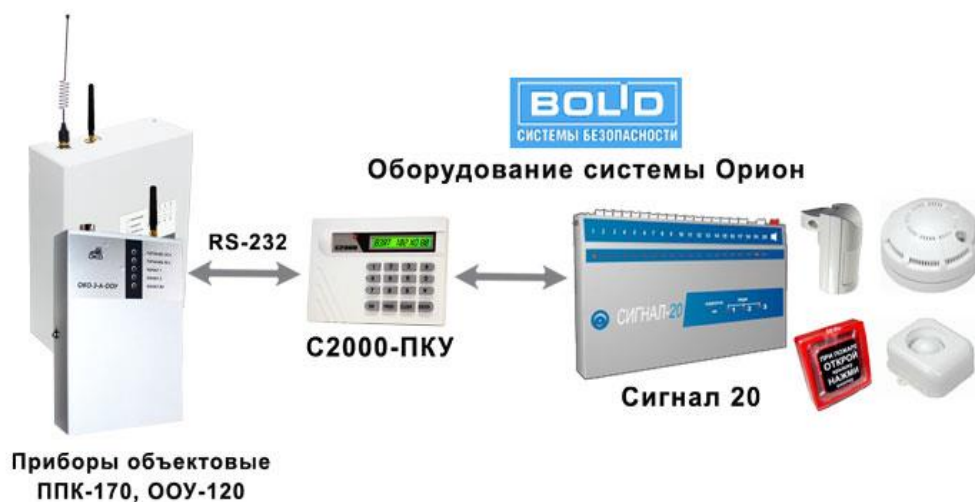
Рис. 3. Подключение оборудования ИС «Орион» к системе «ОКО».
