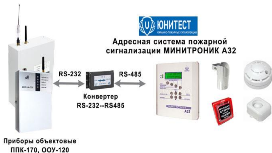
Рис. 5. Подключение АС «Минитроник А32» к системе «ОКО».
