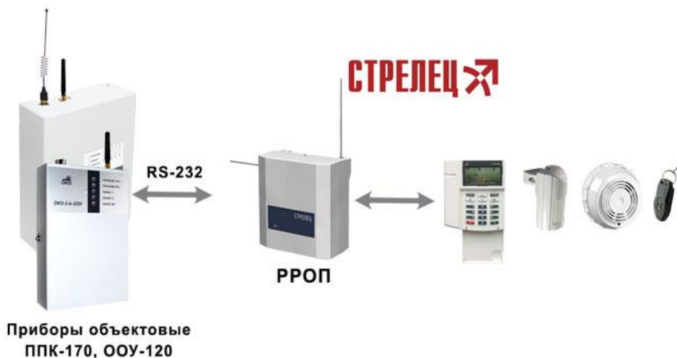
Рис. 2. Подключение ВОРС «Стрелец» к системе «ОКО».
