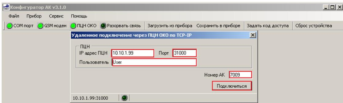
Первоначально устанавливается связь с ПЦН (индикатор «Модуль установил TCP соединение»).
