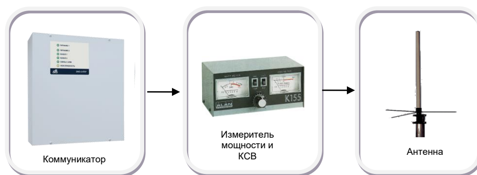
Рисунок 4.3 – Схема соединений при измерении мощности и КСВ
