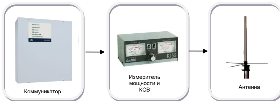
Рисунок 4.3 – Схема соединений при измерении мощности и КСВ
