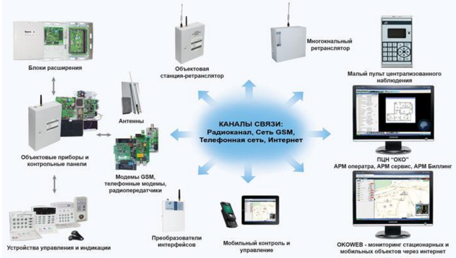
Рис. 1. Структурная схема системы ОКО
