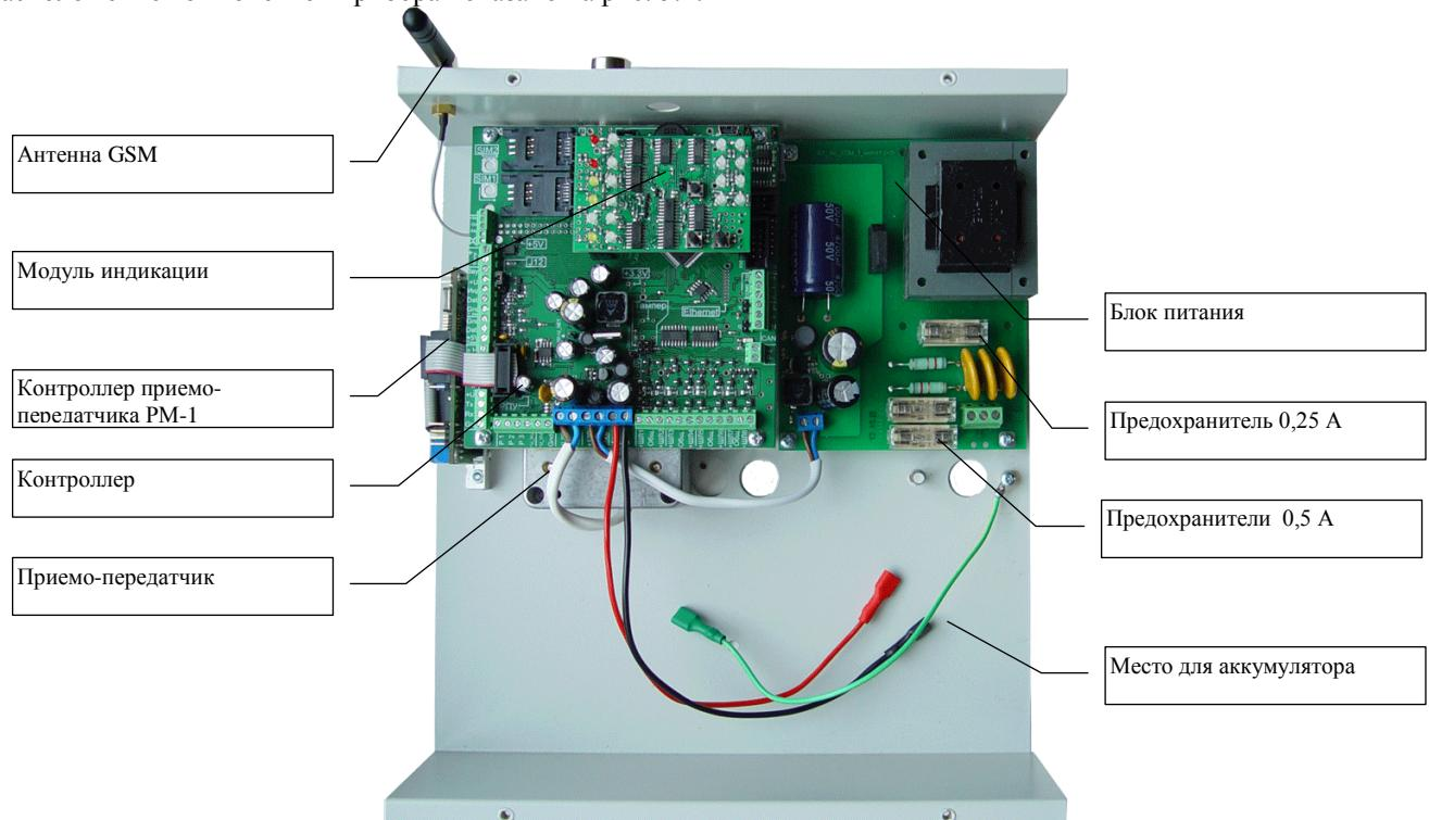
Рисунок 5.1 – Внешний вид базового блока ППК-181Р (с открытой крышкой).
