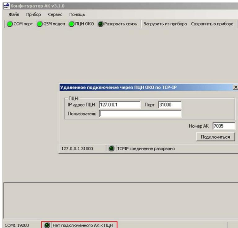
6.21.2.6. Нажать кнопку «Загрузить из прибора». Дождаться полного прочтения конфигурации прибора (индикатор «Конфигурация прочитана»).
