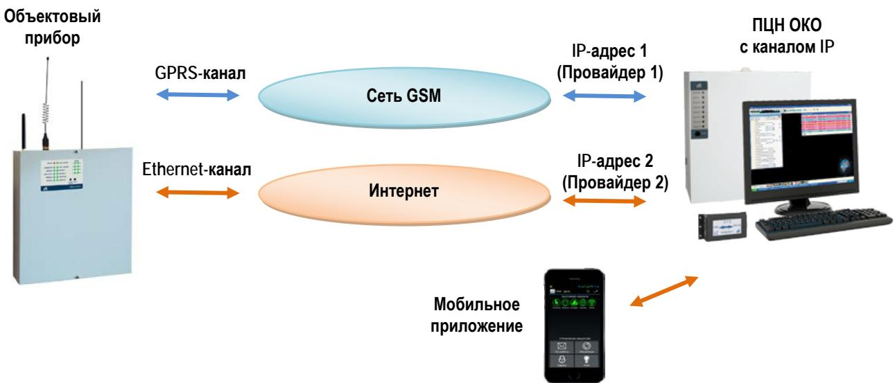
Рисунок 4.2 – Схема связи по GSM и Ethernet каналу.
