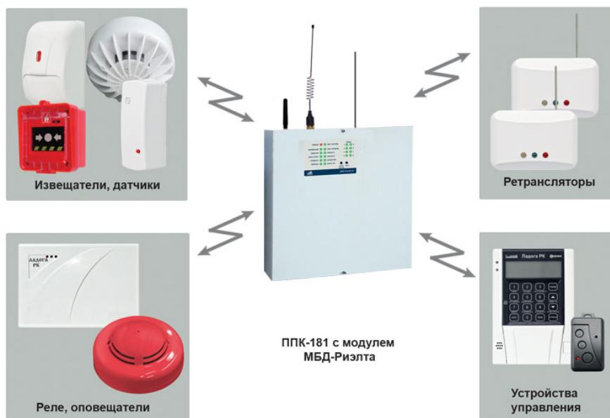
Рисунок 2.3 – Структурная схема взаимодействия прибора с устройствами беспроводной системы Ладога РК
