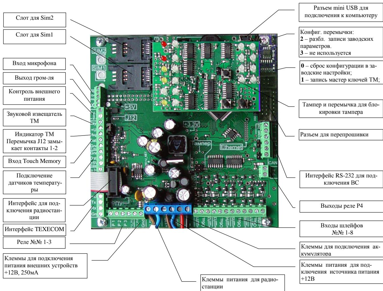
Рисунок 5.2 – Внешний вид платы базового блока ППК-181Р.
