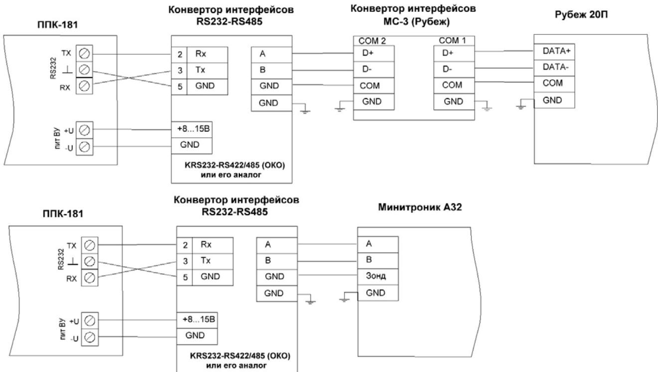
Рисунок П6-б – Схема подключения внешних систем Рубеж 20П (протокол LONTA 202) и Минитроник А32 через интерфейс RS-485.
