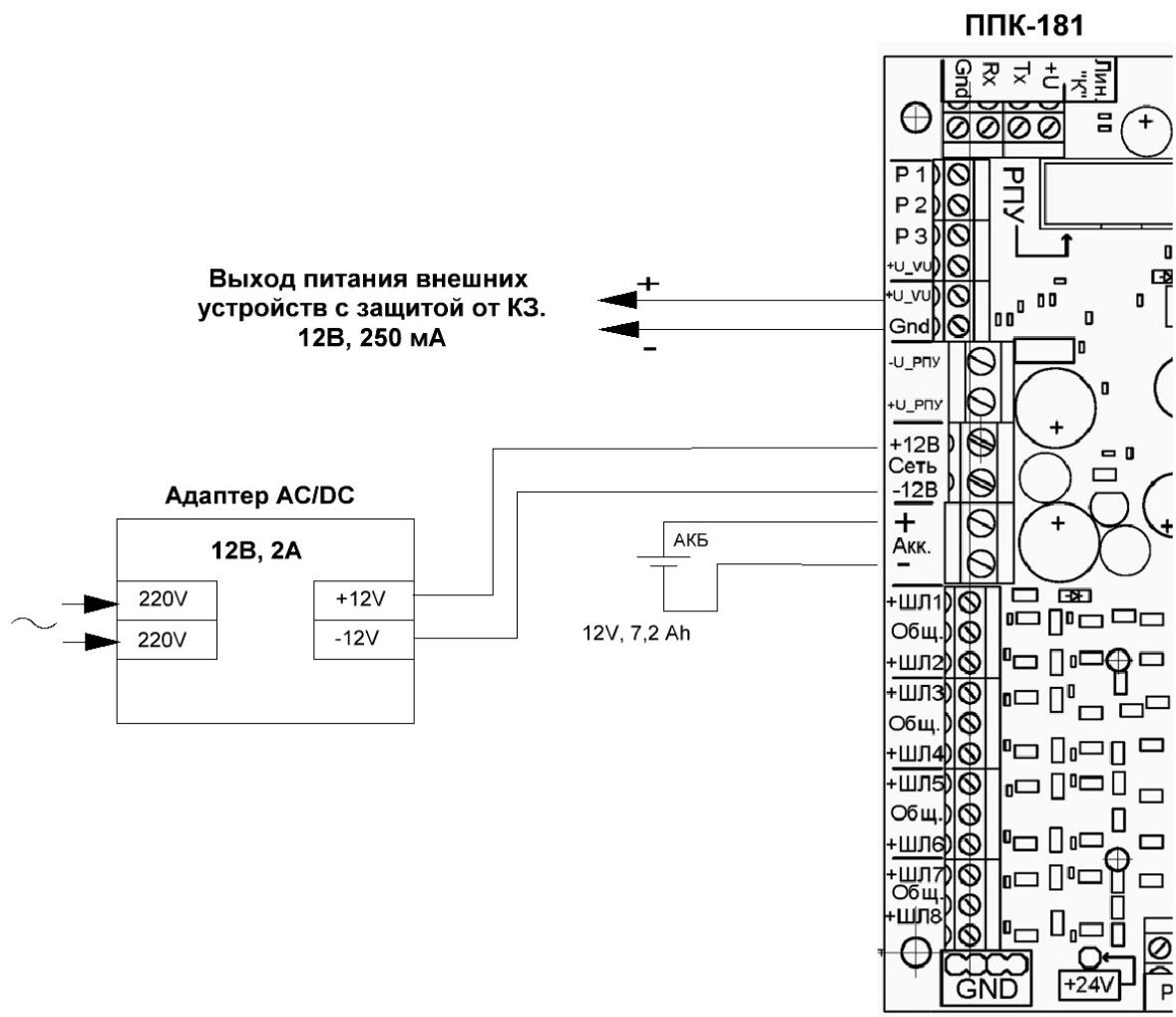
Рисунок П1 - Схема подключения питания к ППК-181Р.
