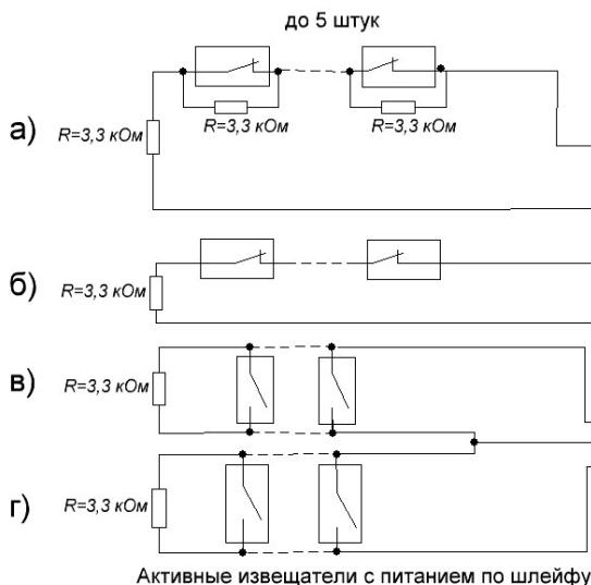
Рисунок П5 – Схема подключения датчиков к базовому блоку ППК-181Р. а) Шлейф с контролем 4-х состояний. б) Шлейф с контролем 3-х состояний с извещателями с нормально замкнутыми контактами. в) Шлейф с контролем 3-х состояний с извещателями с нормально разомкнутыми контактами. г) Активный пожарный извещатель.
