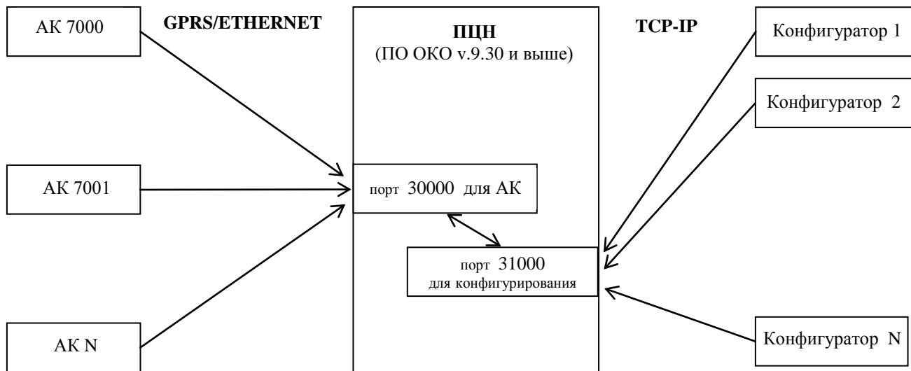
Рисунок 6.3 – Схема связи
