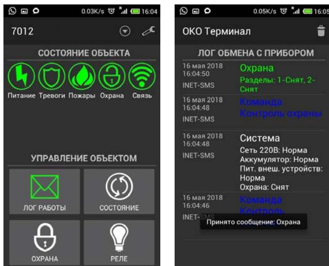
Мобильное приложение может принимать и передавать пользовательские SMS сообщения на прибор, а так же принимать и передавать сообщения через Интернет. При работе приложения через Интернет на ПЧН ОКО должен быть установлен Сервис подключения. Мобильное приложение устанавливает связь с Сервисом подключения и через него получает и отправляет пользовательские сообщения на прибор по GPRS/Ethernet каналу. При отсутствии связи с прибором по Интернету приложение отправляет команды по SMS каналу.
