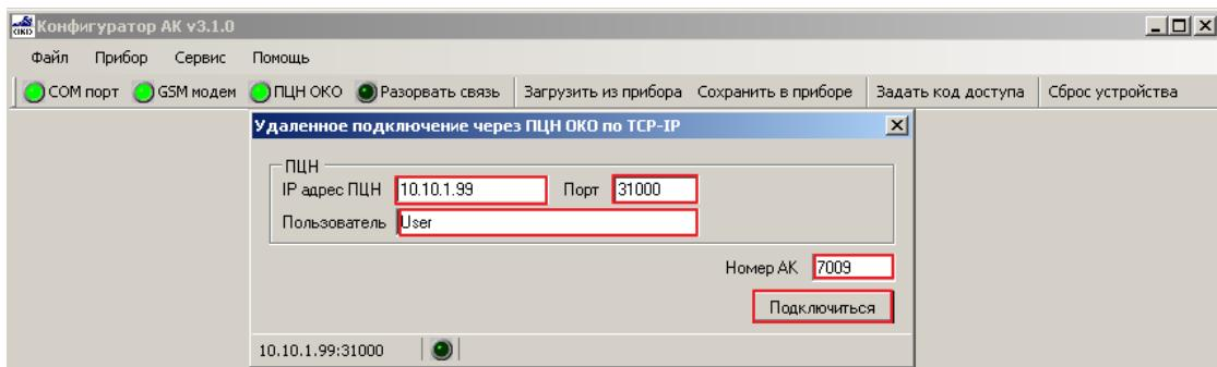
Первоначально устанавливается связь с ПЧН (индикатор «Модуль установил TCP соединение»).
