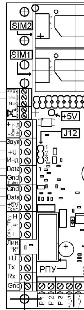
Рисунок П4 - Схема подключения ТМ, микрофона, датчиков температуры.
